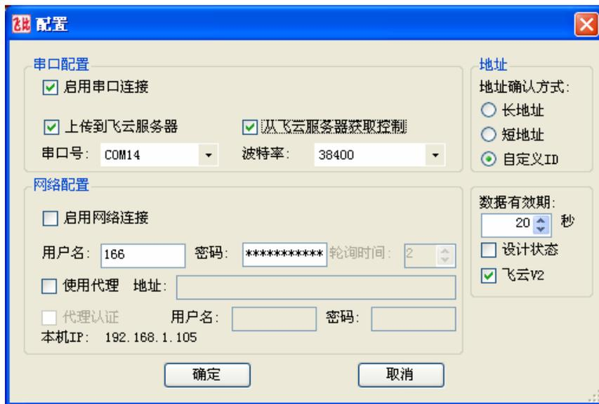
仅需要勾选“上传到飞比云服务器”及“从飞比云服务器获取控制”两个选项后，即开启了本地监控电脑与云服务器的上、下行数据连接；勾选“飞比云 V2”，“轮询时间”变为不可设状态，表明系统不是采用的传统的客户端—服务器轮询模式，而是采用了 html5 的 socket 通讯技术，这将大大提升数据传输的实时性。
