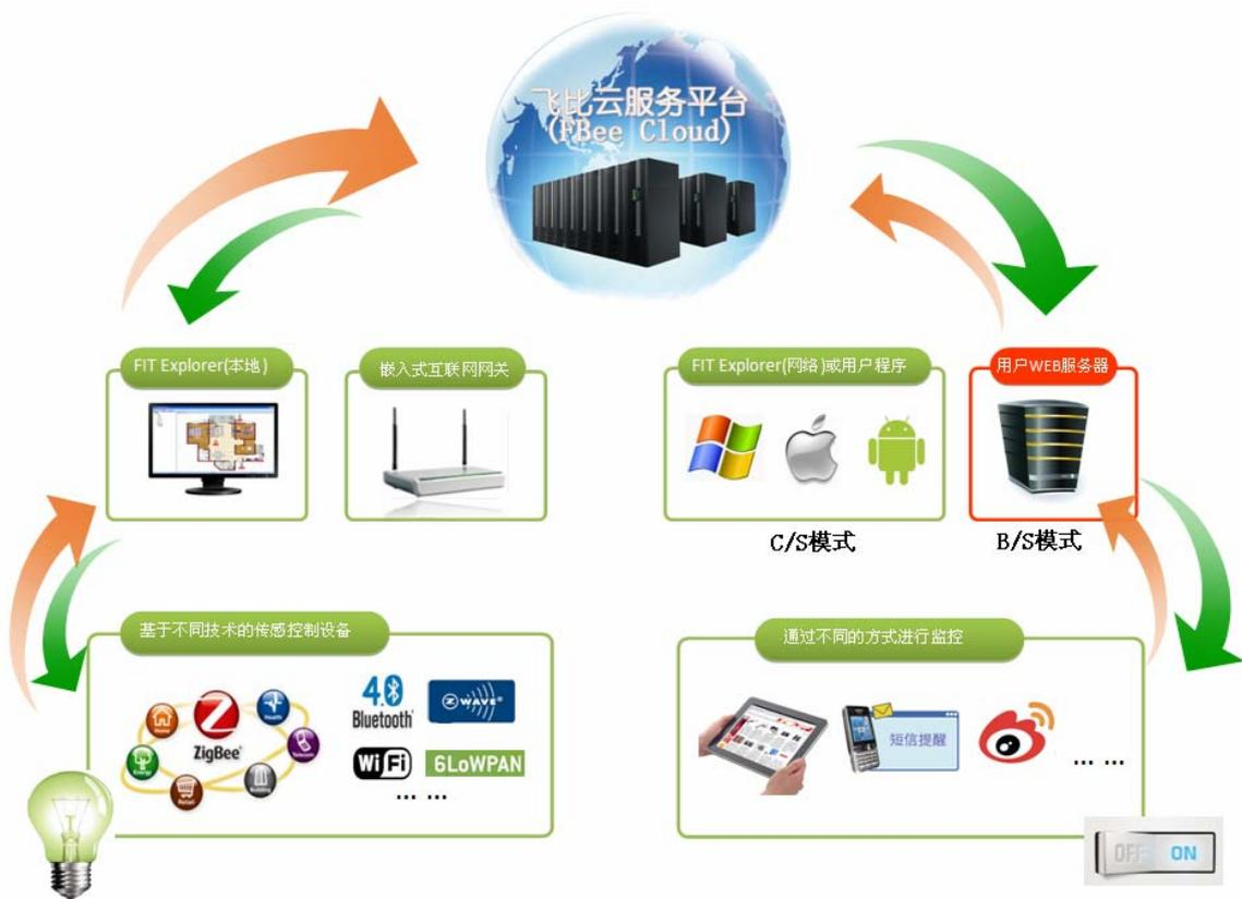
从上述结构图中，可以看到：想让无线传感网设备与服务器建立连接，中间必须有一级设备，我们称之为“网关”。在飞比云架构中，网关可以有两种：一是一台运行 FIT Explorer 软件的、可以上网的电脑；二是嵌入式网关。嵌入式网关将在后续专门章节进行介绍，本文通过 FIT Explorer 软件实现网关功能，并演示 B/S 与 C/S 架构下的采集与控制。
