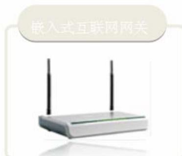
“网关”是“个域网”(如 Zigbee)到互联网的“桥梁”。GPRS 网关、TCP/IP 网关、WIFI 网关、3G 网关都属于这种功能，只是走不同的路，到相同的目的地而已。比如 GPRS 网关走的可能是移动的 GSM 网络，而 TCP/IP 网关走的可能是电信的 ADSL 或者光纤网络等等。
