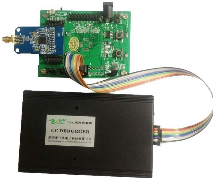
2)、按“快速开始之一、通过串口助手实现本地采集与控制—针对开发平台用户”中提到的烧写方法与文件，分别下载协调器程序至网关 zigbee 协调器模块与 BB 板中。
