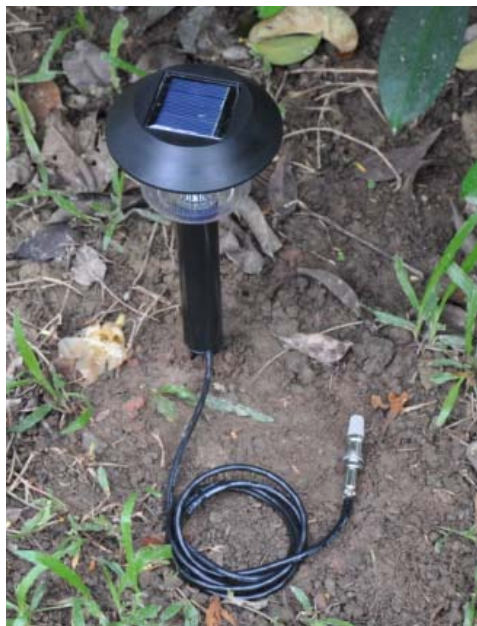
太阳能无线温湿度传感器
